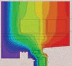
TRASMITTANZA TERMICA LINEICA
