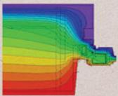
TRASMITTANZA TERMICA LINEICA
