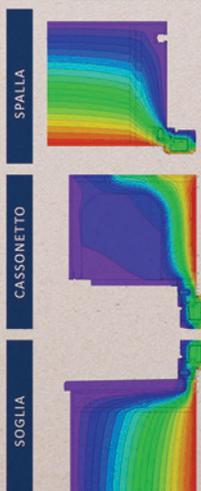
TRASMITTANZA TERMICA LINEICA
