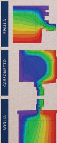
TRASMITTANZA TERMICA LINEICA
