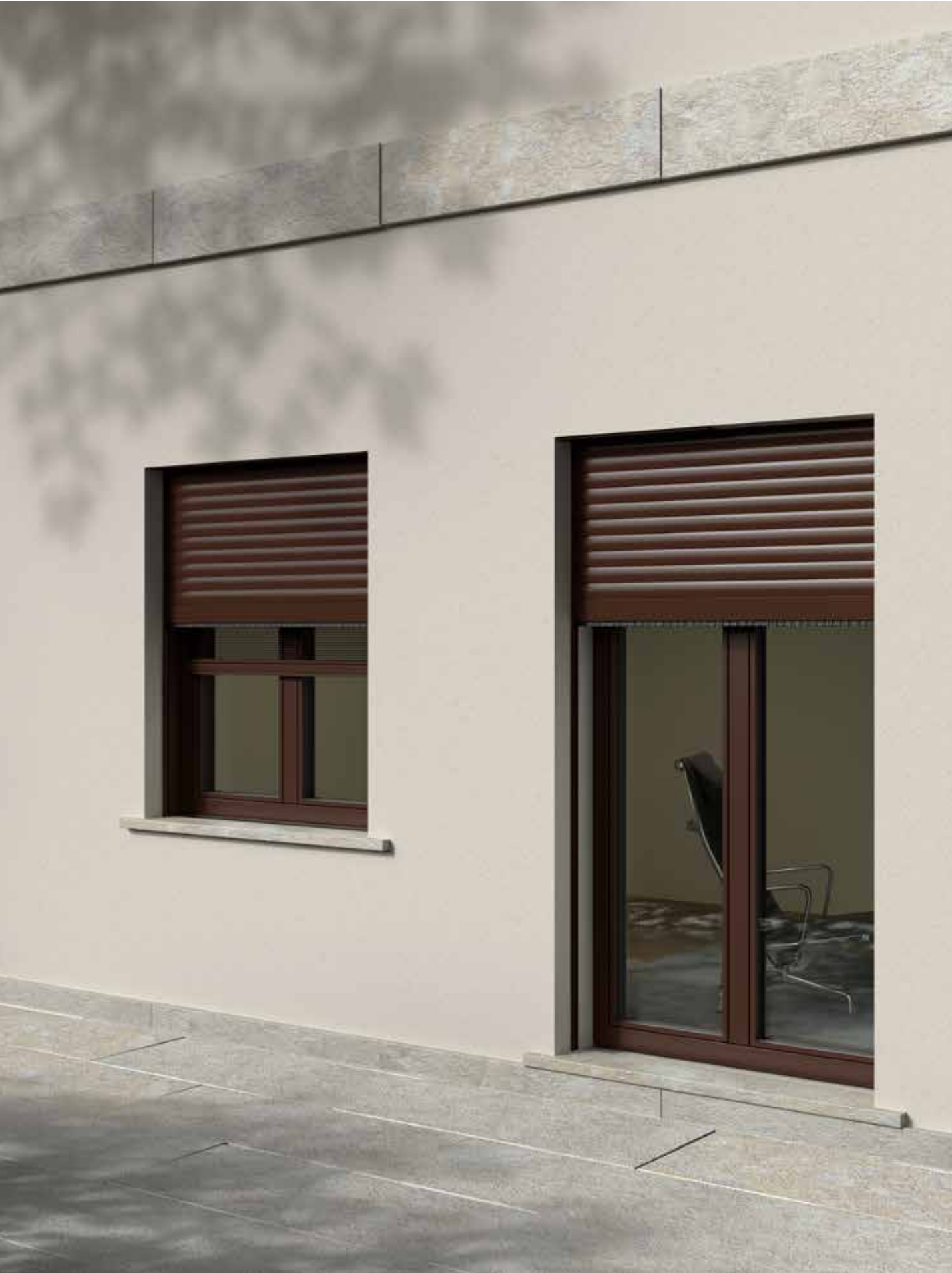
Finestra e porta-finestra FIN-Project Slim-line alluminio-alluminio a due ante, colore pieno M812 marrone rossiccio opaco, avvolgibile con lamelle in alluminio colore G32 rosso ossido, con zanzariera a scorrimento verticale (a sinistra), montaggio su controtelaio.
