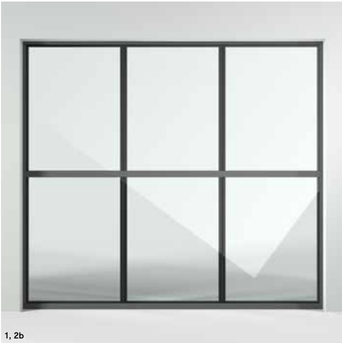
parete vetrata a sei campi con montanti rivestiti di vetro e telaio a scomparsa: zoccolatura rivestita di vetro non realizzabile perché il campo vetrato deve essere sempre supportato da due lati
