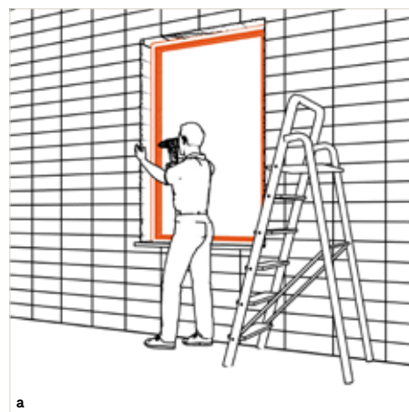
a Montiamo il telaio nella muratura nella fase di costruzione al grezzo.
