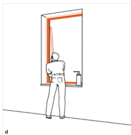
Rivestiamo dall'esterno il vecchio telaio in legno, così è protetto dalle intemperie. Poi agganciamo l'anta.
